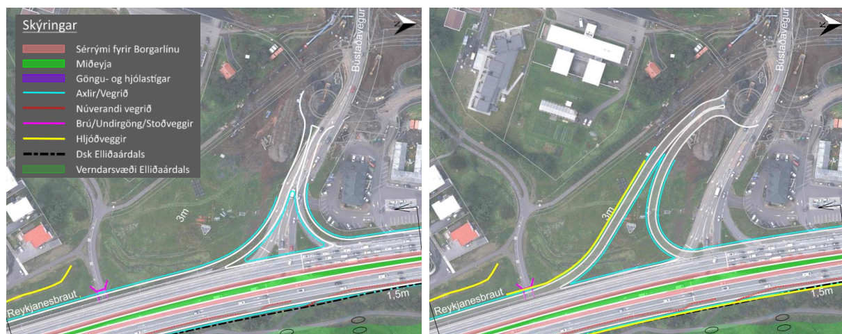
MYND 4.2 Grunnmyndir sem sýna mögulegar útfærslur á „hægri inn og hægri út“ lausn á gatnamótum Bústaðavegar og Reykjanesbrautar. Til vinstri er sýnd útfærsla þar sem lágmarksbreytingar eru gerðar á gatnamótunum. Til hægri er sýnd útfærsla þar sem vegstæði austast á Bústaðavegi er hliðrað til suðurs og gert ráð fyrir plássi fyrir vinstri beygju á brú. Mynd: Loftmyndir og EFLA.
